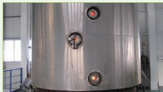
24 对棒节能型多晶硅还原炉
