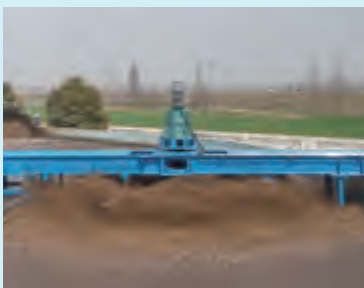
离心自吸混合式倒伞型曝气机安徽来安应用
