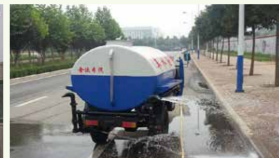
道路洒水控制扬尘
